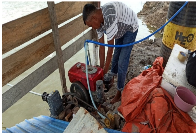
Gambar 2. Mesin 8 PK Untuk Penggerak Kincir Air.
