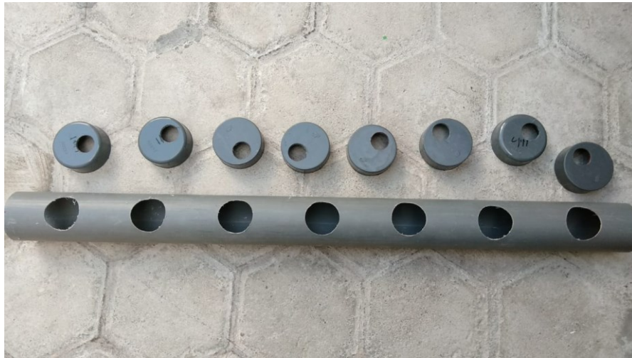
Gambar 6. Pipa Yang Telah Dilobangi.
