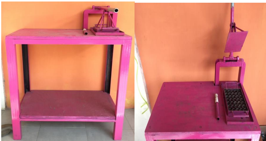
Gambar 8. Hasil rancangan alat pencetak kompos tablet
