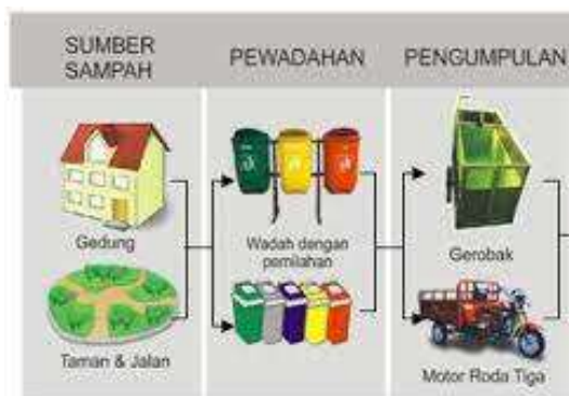
Gambar 17. Teknis Persampahan dari Sumber Sampah Hingga Pengumpulan Sumber: (Harsari, 2016)
