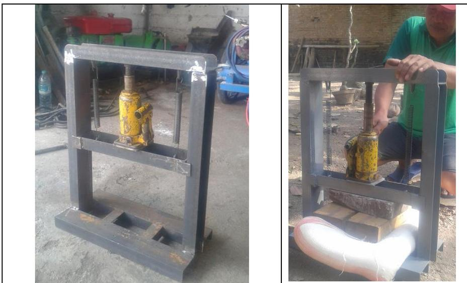
**Gambar 4.** Mesin hidrolis penekan adonan basah krupuk singkong
