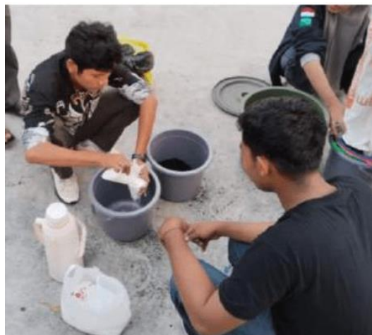
Gambar 2. Proses pencampuran tepung arang dan perekat
