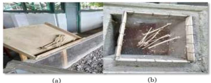
**Gambar 7.** Perlengkapan Penelitian; (a) Boks Bambu ukuran 40 cm x 30 cm, (b) Saringan ukuran 40 cm x 30 cm
