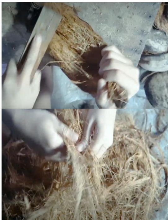
Gambar 2. Proses Penggosokan dan Sortir Sabut Kelapa Menggunakan Sikat Kawat
