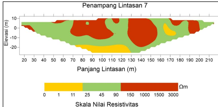
**Gambar 4.** Penampang struktur resistivitas pada lintasan 7
