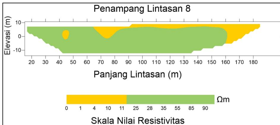
**Gambar 5.** Penampang struktur resistivitas pada lintasan 8
