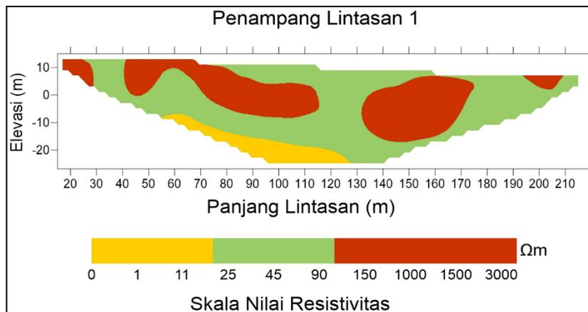
**Gambar 2.** Penampang struktur resistivitas lintasan 1
