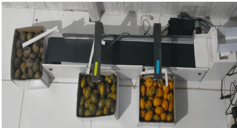
**Gambar 6.** *Prototype* sensor kematangan buah
