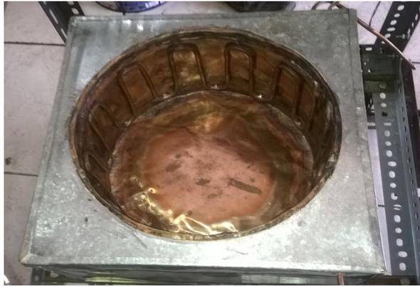
**Gambar 3.** Tampilan box cooler berbahan tembaga yang dilengkapi styrofoam sebagai isolator termal
