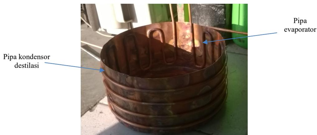
**Gambar 2.** Desain detail evaporator mesin pendingin dan pipa kondensor destilasi yang dimasukkan ke dalam box cooler
