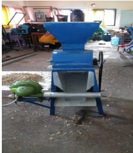
Gambar 1. Mesin Pengupas kacang tanah
