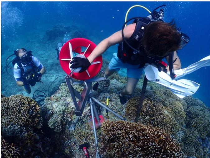
**Gambar 2.** Pemasangan Anoda Katoda
