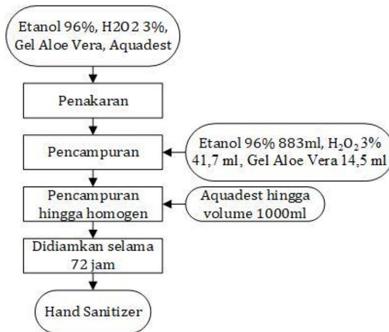
**Gambar 2.** Diagram Alir Pembuatan *Hand sanitizer*
