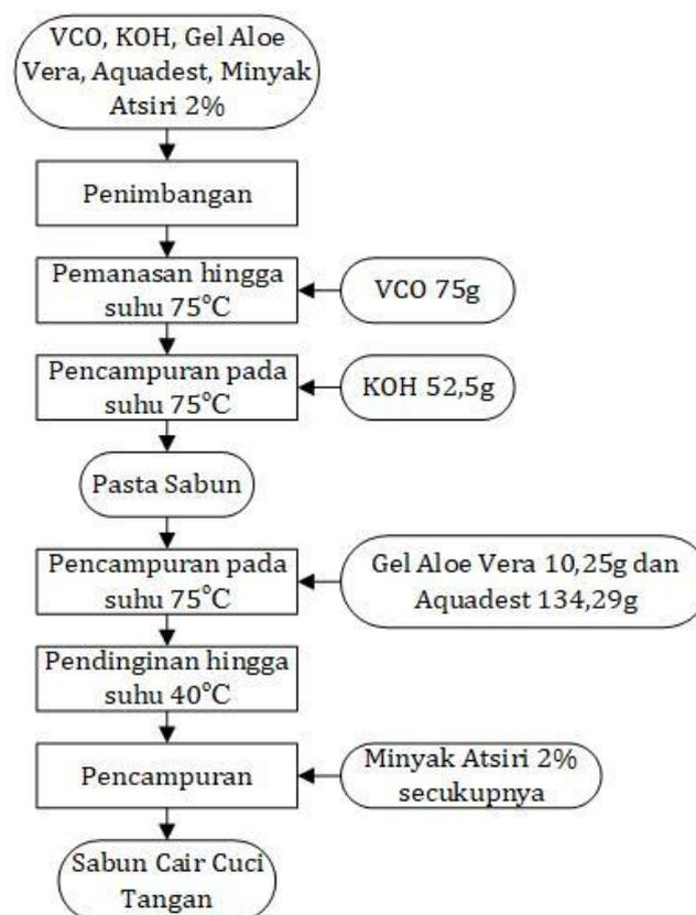
**Gambar 1.** Diagram Alir Pembuatan Sabun Cuci Tangan
