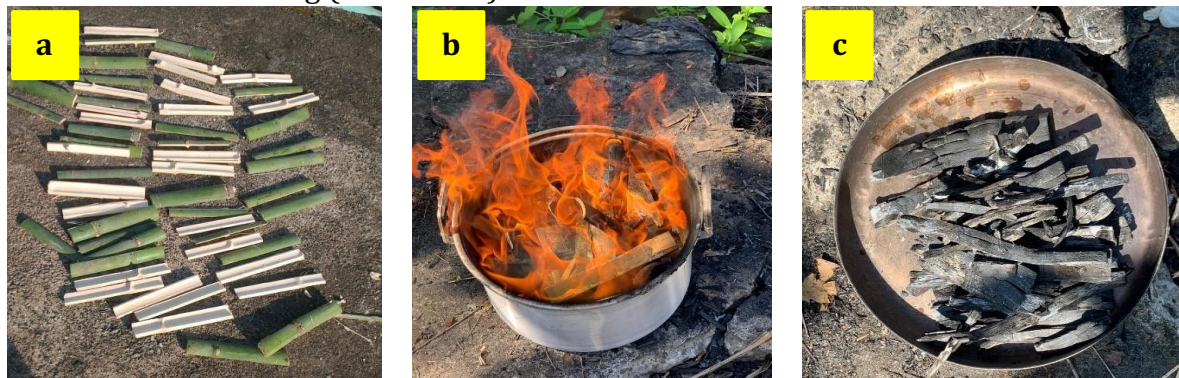
Gambar 1 a). Pengeringan bambu; b) Karbonisasi; c) Arang bambu
