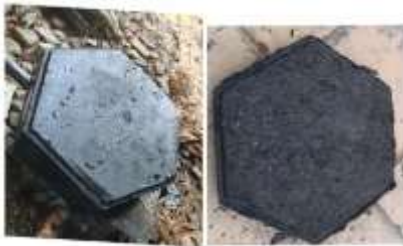
Gambar 4. Produk Paving Blok Hasil Pemanfaatan Sampah Plastik
