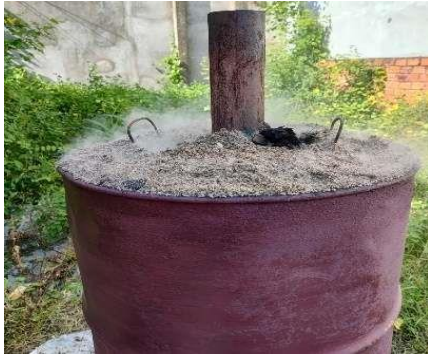
Gambar 3. Drum besi pembakaran dengan metode tangsir
