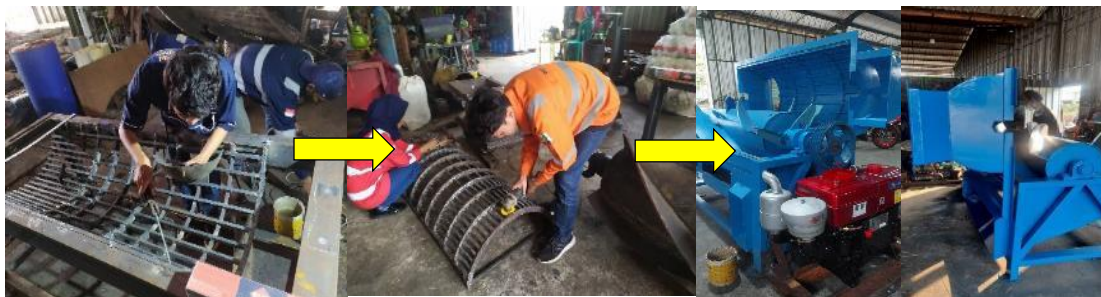
Gambar 3. Tahapan pembuatan TTG Mesin pemilah sampah 4 ton/jam, penggerak motor diesel daya 26 HP
