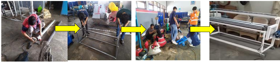
Gambar 6. Tahapan pembuatan TTTG mesin roller ecoprint berpengerak motor servo
