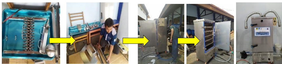
Gambar 5. Tahapan pembuatan TTG Mesin steamer, rak 5 tingkat, dengan control suhu dan berbahan bakar gas
