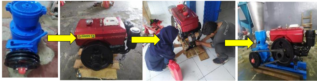
Gambar 4. Tahapan Pembuatan TTG mesin cetak vertical twin die daya penggerak motor diesel 8 HP.
