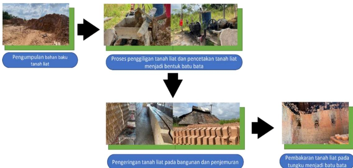
**Gambar 2.** Alur Proses Pembuatan Batu Bata pada Mitra
