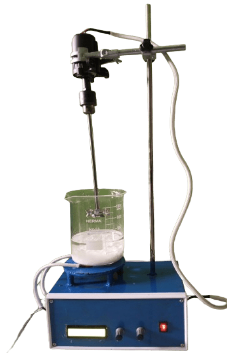
Gambar 4. Inovasi teknologi Hot Stirrer – IoT
