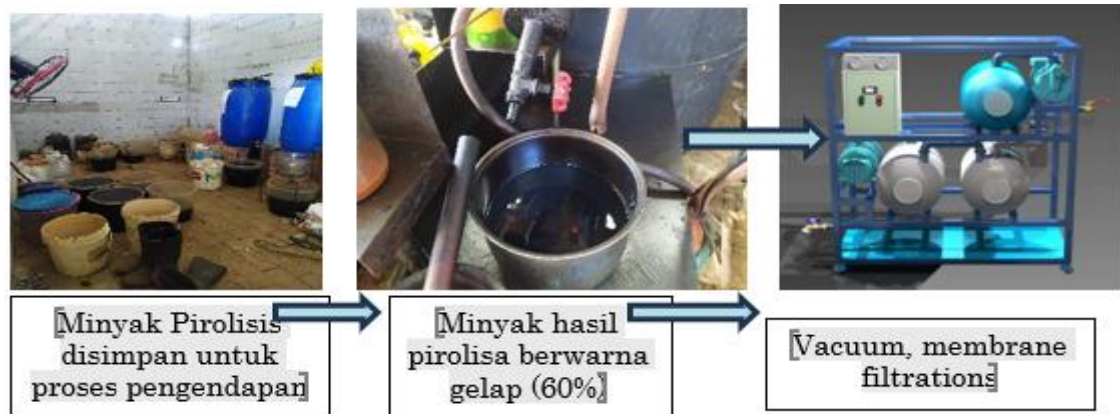
Gambar 4. Skema Penerapan Teknologi Vacuum Filtrations Minyak Pirolisis dengan Membrane
