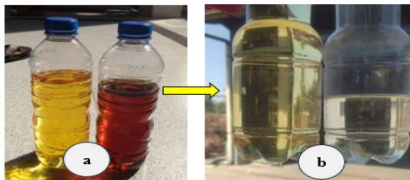
Gambar 5. Hasil Minyak Pirolisis Setara Solar Dan Premium (a) Sebelum Filtrasi, (b) Sesudah Difiltrasi
