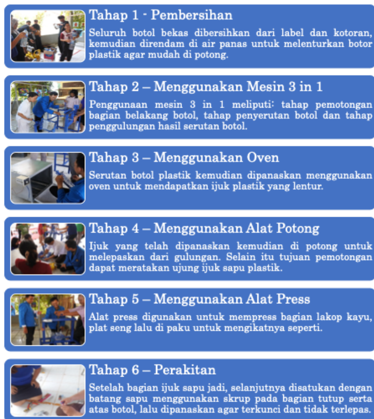
Gambar 4. Tahapan Pengolahan Limbah Botol Plastik Menjadi Sapu Ijuk
