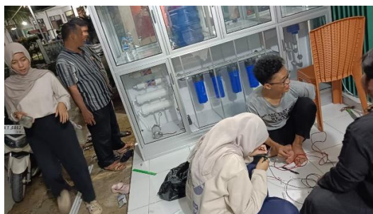
Gambar 3. Perakitan sistem pengolahan air minum berbasis teknologi membran
