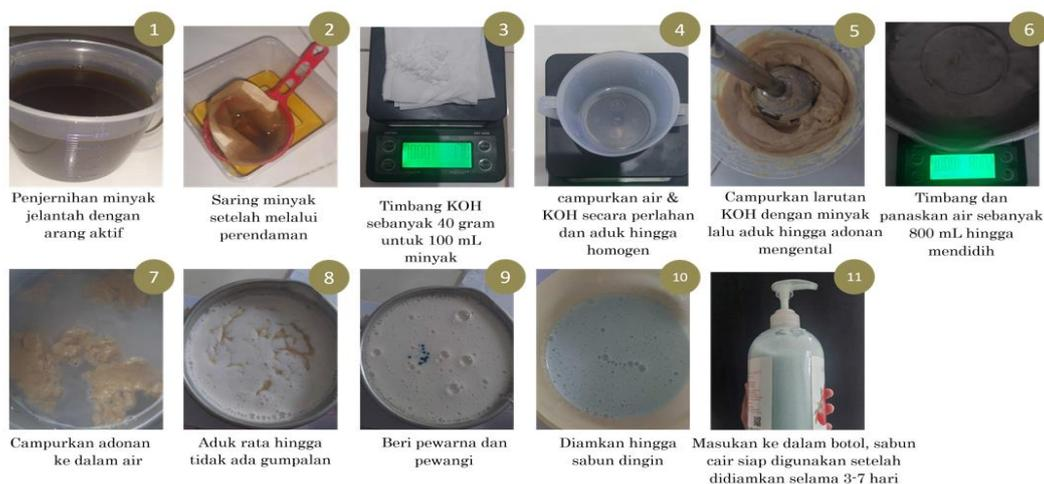
**Gambar 2.** Proses pembuatan sabun cair berbahan dasar minyak jelantah
