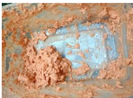
Gambar 3. Pengenceran limbah karet dengan pertasol pada rasio 1:5
