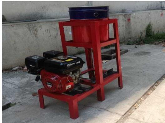
**Gambar 4.** Mesin Pencacah Tanaman
