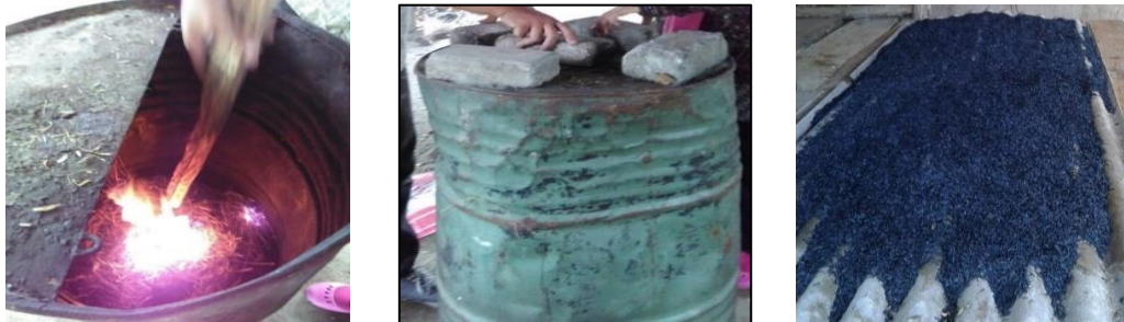
Gambar 2. Pembuatan Biochar sekam padi
