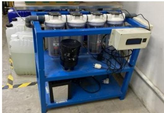
**Gambar 2.** Rancangan alat degradator dengan konsep sistem aliran semikontinyu konfigurasi multiple series dilengkapi sensor degradasi realtime
