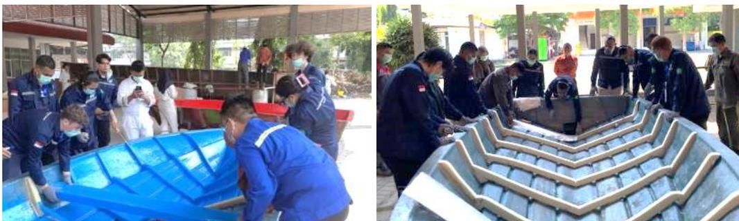
**Gambar 5.** Proses laminasi lambung dan penguat/gading kapal
