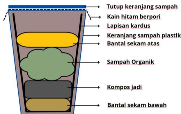
**Gambar 1.** Ilustrasi keranjang Takakura
