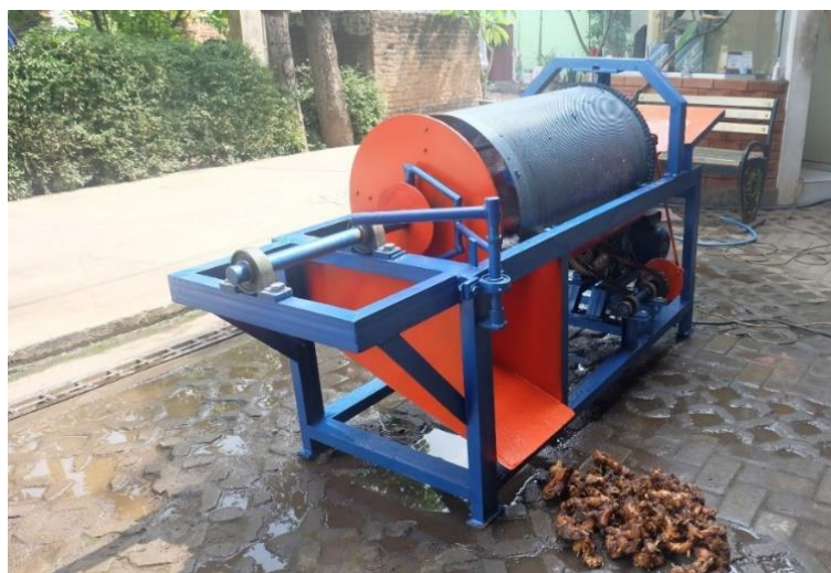
Gambar 4. Mesin pencuci lengkuas saat uji coba
