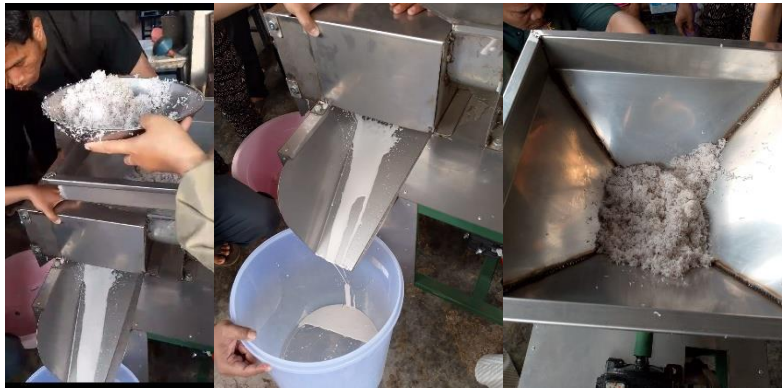
Gambar 4. Demonstrasi produksi minyak kelapa menggunakan mesin peras santan otomatis tipe screw
