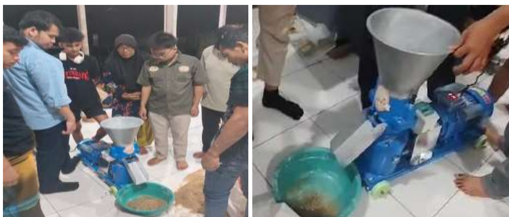
Gambar 2. Pengoperasian Alat Pembuatan Pelet Pakan Ayam
