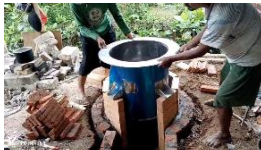
Gambar 2. Ketel masakan bahan tahu hasil PkM berbahan stainless steel
