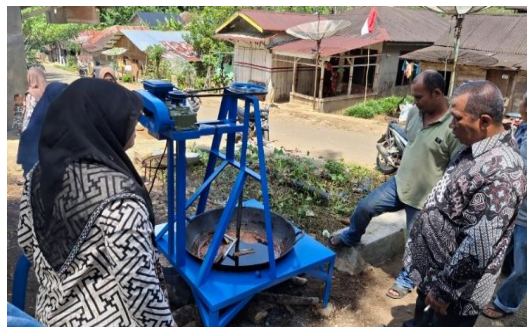
Gambar 3. Uji coba alat pengaduk otomatis dalam proses produksi dodol.
