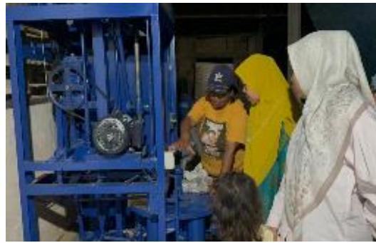
Gambar 1. Praktek penggunaan alat press hidrolik untuk press baglog
