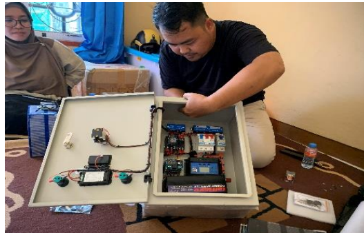
Gambar 4. Proses Perakitan aki, inverter dan pemasangan panel surya
