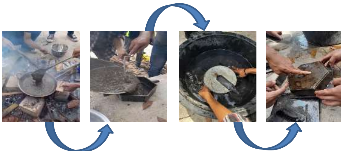
Gambar 4. Proses pembuatan Paving block berbahan dasar limbah sampah plastik
