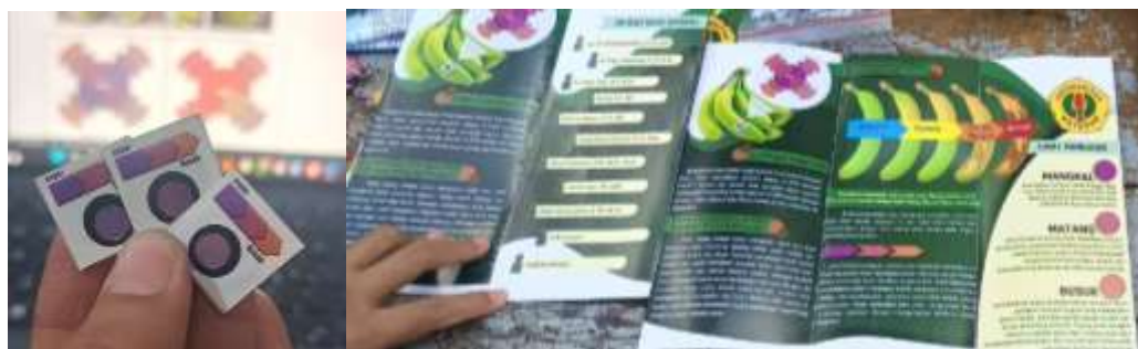
Gambar 4. Produk yang dihasilkan berupa prototipe label indikator kesegaran pada buah pisang dan leaflet berisi informasi dan prinsip kerja label indikator
