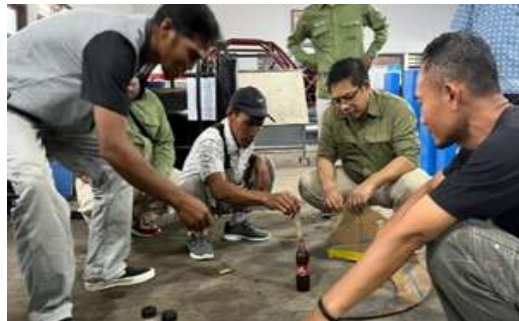
Gambar 2. Uji nyala minyak pirolisis sampah plastik
