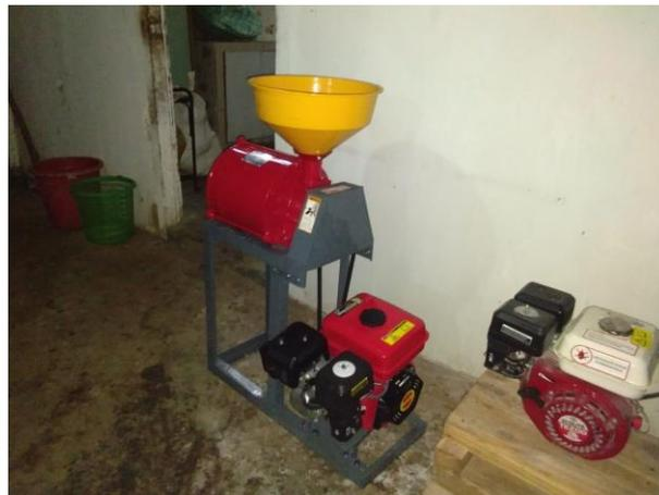
**Gambar 5.** Mesin Pengupas dan Penggiling
