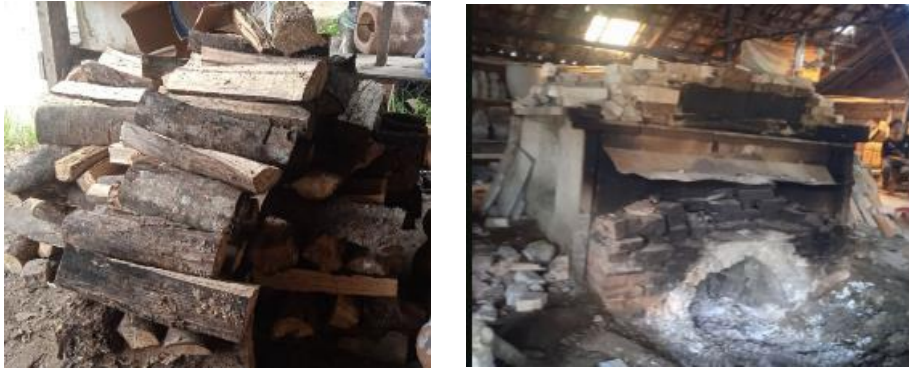
Gambar 5. Kayu dan Tungku untuk proses pembakaran
