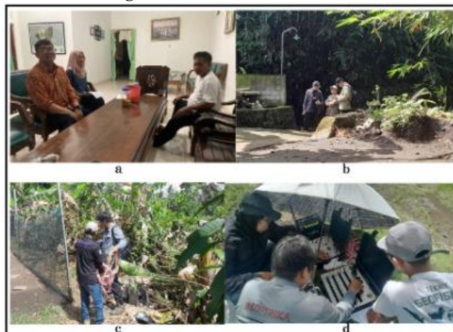
Gambar 1. a) Sosialisasi awal bersama dukuh Senoboyo, b) Penentuan lintasan c) Pemasangan kabel dan elektroda, d) Akuisisi data
