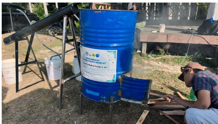
Sumber: Dokumentasi Pribadi Gambar 1. Alat Produksi Asap Cair
