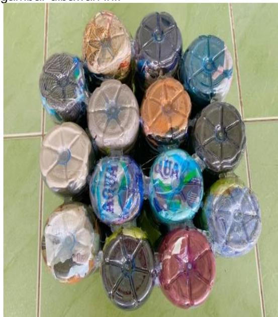
**Gambar 8.** Bentuk Pola Circle Ecobrick
