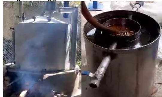
Gambar 2. Penyulingan minyak nilam
