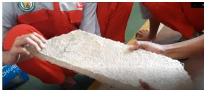
Gambar 9. Hasil pembuatan bodi dengan serat pelepah pohon pisang
