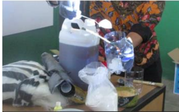
Gambar 7. Demonstrasi pencampuran talk dan resin untuk lapisan pertama bodi
