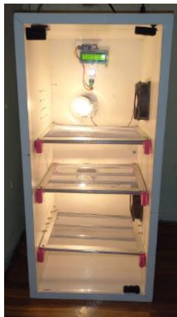
Gambar 4. Kondisi Ruang Fermentasi Kedelai Menjadi Tempe Saat Lampu Menyala
