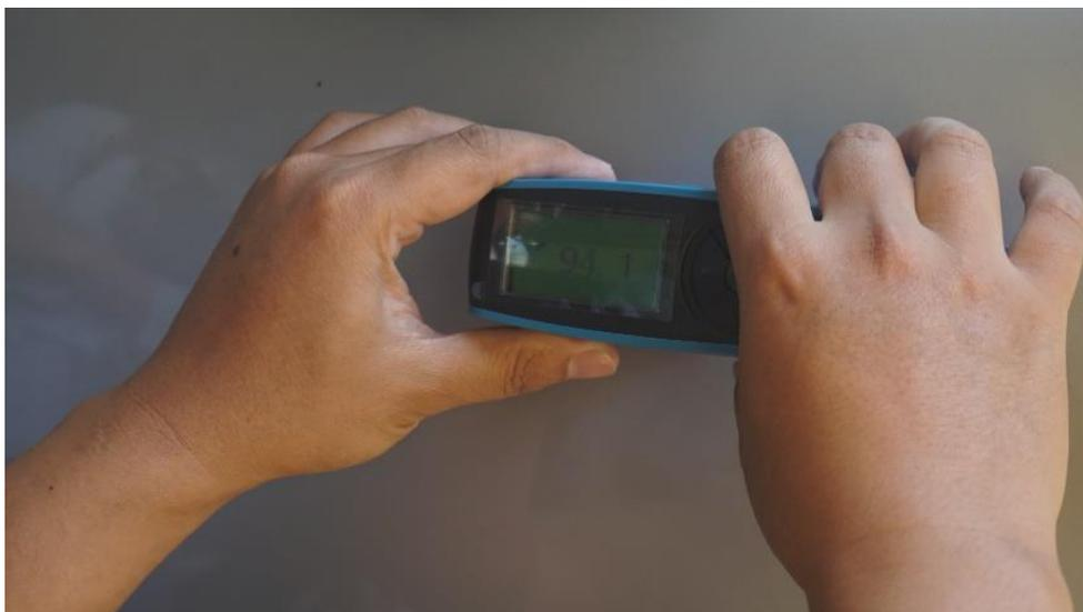
**Gambar 8.** Pengukuran Setelah Finishing Menggunakan Mesin Rotary Polisher
