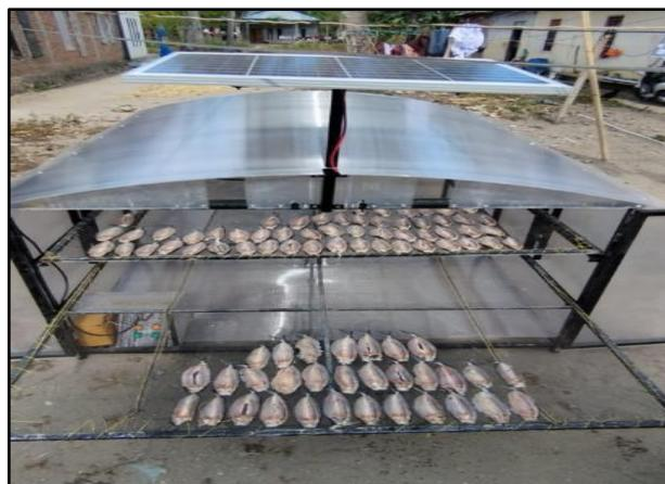
**Gambar 2.** Inovasi alat pengeringan ikan berbasis solar dryer
